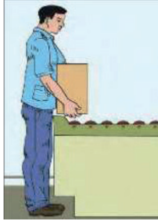
Görsel 1.15: Çalışan için üst vücut ve ayak mesafesine uygun bant yüksekliği
