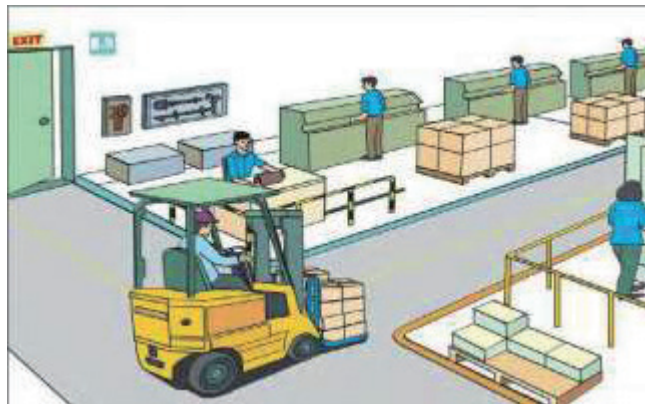
Görsel 1.14: Taşıma yolunun çalışma alanlarında çizgilerle ayrılması ve taşıma yolunun temiz tutulması
