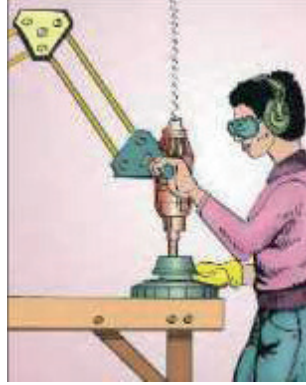
Görsel 1.24: El aletlerinin ağırlığının azaltılması
