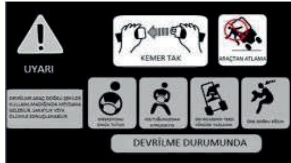
Görsel 1.42: Forklift devrilmesi durumunda yapılacaklar
