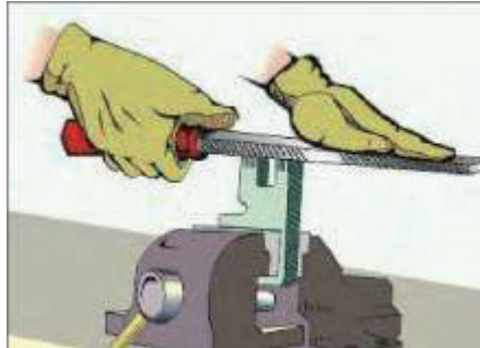
Görsel 1.23: Mengene ve kısıkaçların kullanımı
