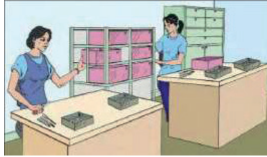
Görsel 1.16: İş bölümlerine ara stok raflarının konması ve ürünün direkt geçişinin sağlanması
