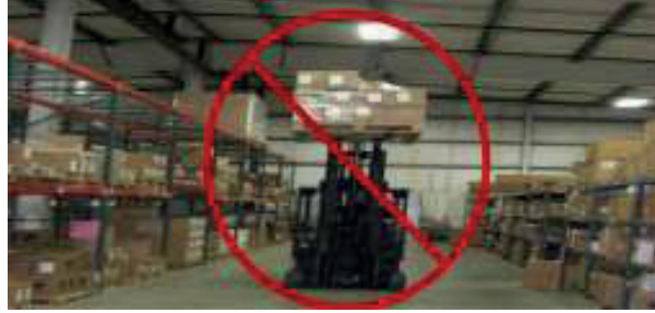
Görsel 1.39: Çatallar yukarıdaki iken hareket eden bir operatör
