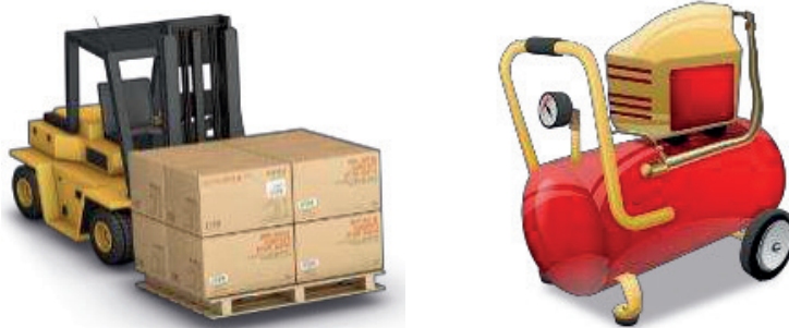
Görsel 1.6: Çalışırken salınım hareketi oluşturan araç gereç ve makineler
